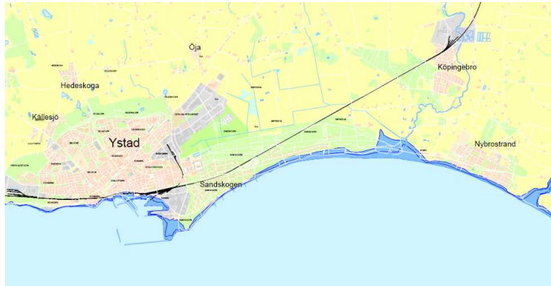
Fig. 2. Detalj ur karta på översvämningssanalys vid havsytehöjning på 1 resp. 2 m från Klimat- och sårbarhetsutredningen (2007)
